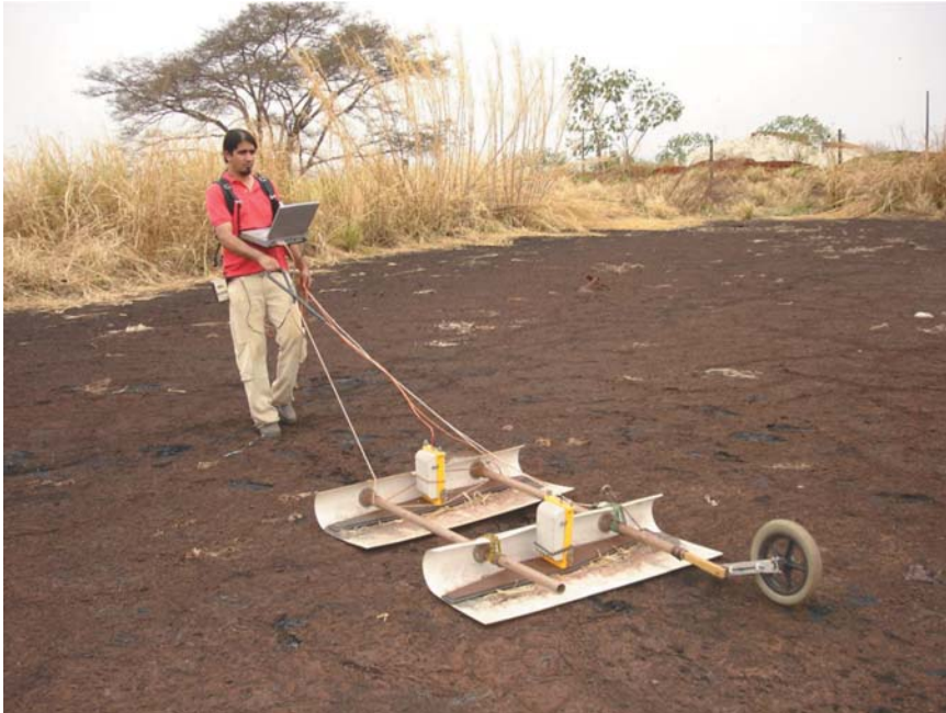
Figura 3 – Aquisição de dados GPR utilizando antenas não-blindadas de 100 MHz (Ramac I, Mala Geoscience) sobre um trenó de PVC e odômetro.
